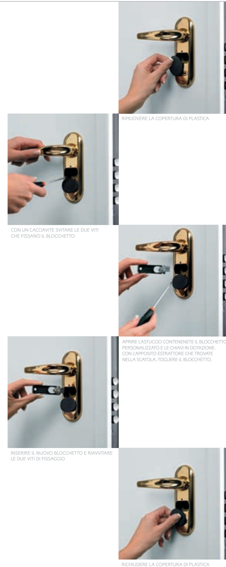
RICHIUDERE LA COPERTURA DI PLASTICA
